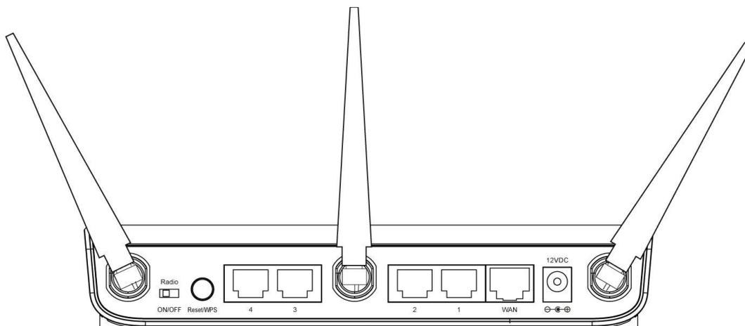
2. Ligar o seu xDSL / modem de cabo a uma porta WAN do encaminhador através do cabo Ethernet.
