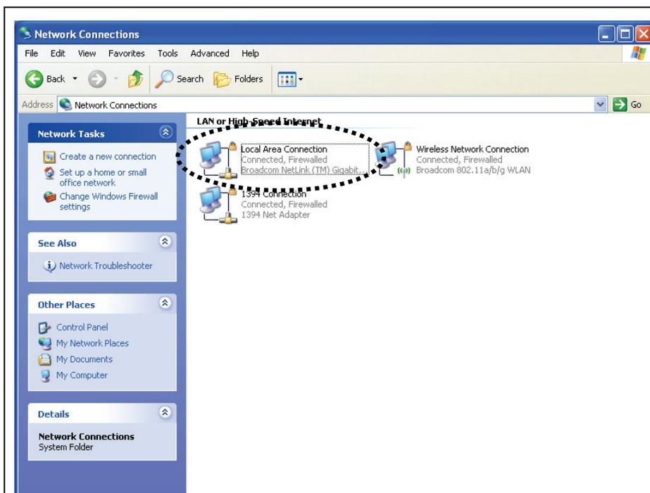
1. Definir o seu computador para obter um endereço IP do encaminhador sem fios: clicar o botão 'Start' (deve estar localizado no canto inferior esquerdo do seu computador), depois clicar no painel de controlo. Clicar duas vezes **Network Connections**, depois clicar à direita **Local Area Connection** e clicar em 'Properties'.
